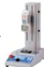
押す力と速度を精密に調節することで再現性の高い測定が可能。荷重-時間グラフの作成が可能。
